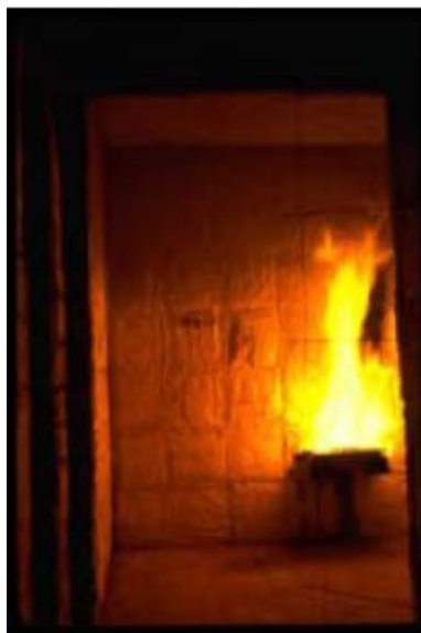
Рис. 5.12 Фотография пожара мощностью 100 кВт, горелка расположена у задней стены одной из небольших комнат (серия испытаний NBS в стенде из нескольких комнат)
