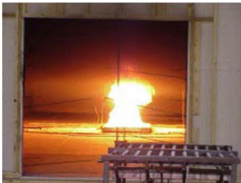
Рис. 5.6 Фотография горения гептана мощностью 1 МВт через дверной проем. Фотография предоставлена Энтони Хэминс (NIST)
