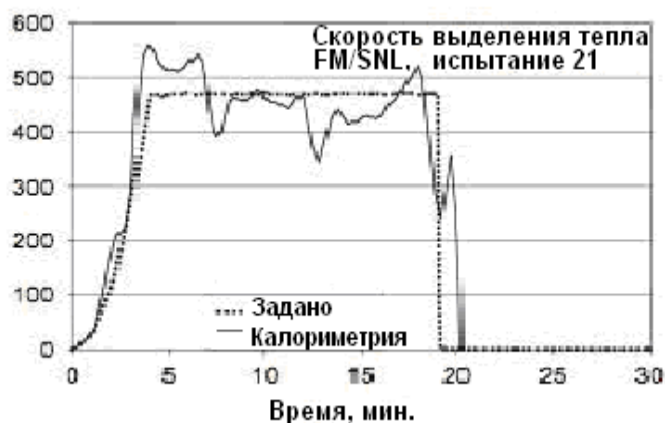
Рис. 5.11 Прогнозируемые (пунктир) и измеренные (сплошная линия) значения скорости выделения тепла как функция времени в ходе Испытания 21 серии испытаний лабораторий FM/SNL
