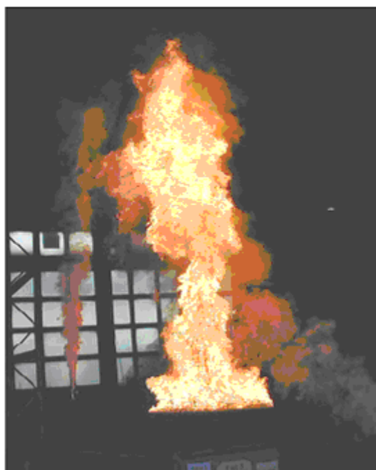
Рис. 5.4 Фотография горения гептана мощностью 2 МВт в испытаниях VTT в большом зале. Фотография предоставлена Симо Хостикка (VTT)
