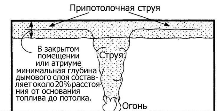
(c) Образование дымового слоя минимальной глубины в замкнутом помещении
