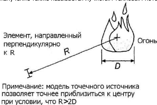
Рис. 17 Модель точечного источника теплового излучения
