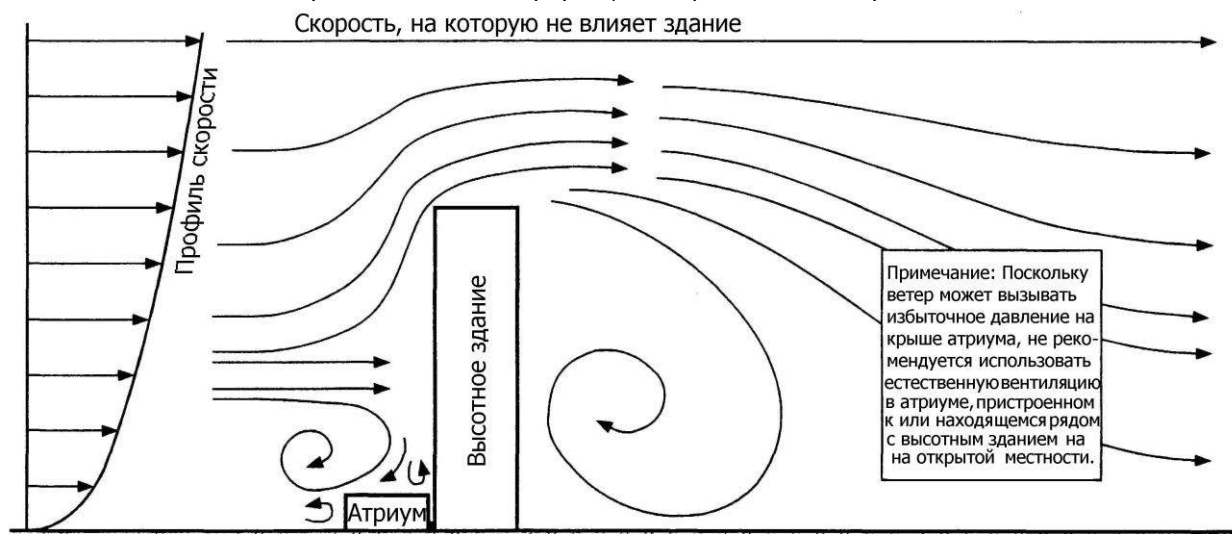
Рис. 14.10 Схема ветрового потока, вызывающего избыточное давление на крыше атриума при наличии рядом высотного здания
