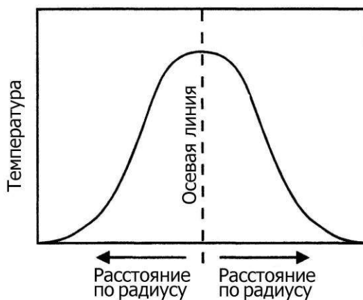
Рис. 13.2 Изменение радиальной температуры осесимметричной струи
