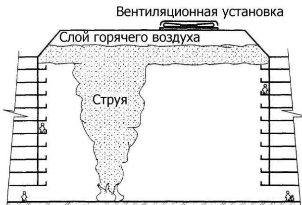
Рис. 14.12 Стратификация дыма под слоем горячего воздуха
