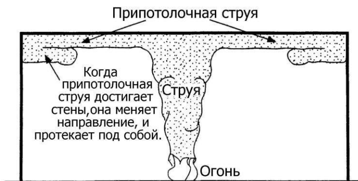
(b) Припотолочная струя, достигшая стены и повернувшая назад
