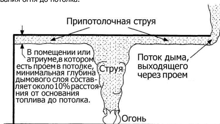
Рис. 13.22 Дымовой слой в помещении или атриумах, где есть проем в потолке
